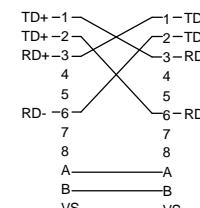
Die Kontaktverbindung ist nur schematisch zur Erklärung.
